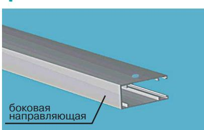
Отрезать боковые направляющие в размер, равный высоте изделия, минус 43 мм. Зафиксировать щетку в направляющих клеммами. Вставить нижнюю часть направляющей в шаблон и просверлить отверстие диаметром 4,1 мм ближе к внутренней стороне направляющей (рис. 3-5 «Шаблоны...»).
