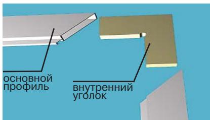
Отрезать основной дверной профиль в размер, равный габаритам изделия по ширине и длине. Затем соединить профили с помощью внутренних уголков.
