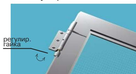
Сила и скорость закрывания двери регулируется с помощью пластмассовой гайки, входящей в комплект СЗМ. Для регулировки усилия необходимо повернуть гайку по (или против) часовой стрелки в зависимости от расположения механизма и, надавив на нее, зафиксировать в шестигранном пазу. Чем на больший угол будет повернута регулировочная гайка, тем больше сила и скорость закрывания двери. Когда регулировочная гайка не зафиксирована в пазу, дверь находится в свободном состоянии.
