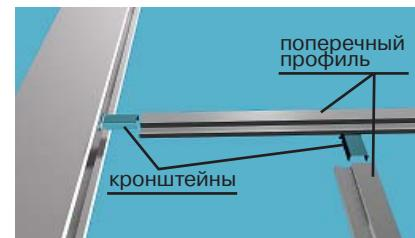
Вставить алюминиевые кронштейны в поперечный профиль и соединить его с основным профилем.
